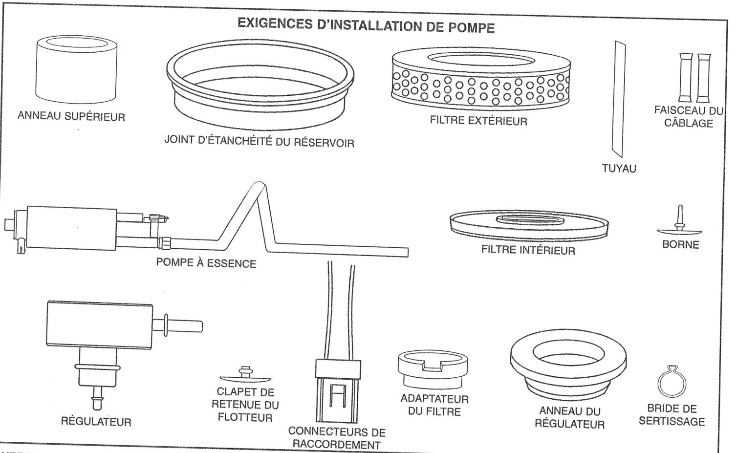
**AVERTISSEMENT:** Cette pompe d'injection ratait NE MARCHE PAS sur les circuits de mélange carburé. Elle est destinée uniquement aux circuits d'injection électronique.
