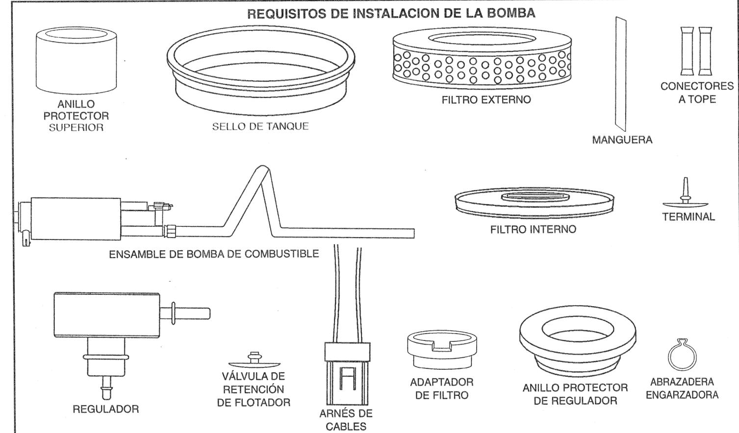
**ADVERTENCIA:** Este bomba giratoria de inyección de combustible NO funcionará en sistemas de carburación de combustible. Es para usar solamente con inyección electrónica de combustible.
